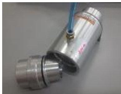
Figura 1: Eyector comercial referencia ZH30-X185 de la marca SMC®.
